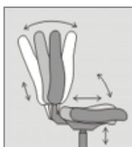
Sitz und Rückenlehne folgen den Bewegungen des Sitzenden synchron im richtigen Winkelverhältnis. Arretierungsmöglichkeit der Rückenlehne in 5 Positionen. Seitliche stufenlose Federkrafteinstellung des Rückenlehnenegendrucks im Bereich von ca. 50-135 kg Körpergewicht. Synchron-neigung 5-fach arretierbar. Dynamisches Sitzen.
