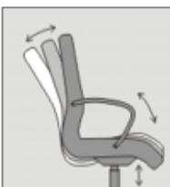
Sitzschale folgt permanent Bewegungen des Oberkörpers. Rückenlehnen gegen Druck im Bereich von ca. 50 – 125 kg Körpergewicht. Arretierung in 5 Positionen möglich.
