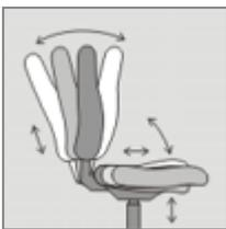
„V“ Mechanik der neuesten Generation. Die Synchronmechanik garantiert perfektem Komfort und Ergonomie dank optimaler Anpassung. Sitz und Rückenlehne folgen synchron den Bewegungen des Sitzenden im richtigen Winkelverhältnis Arretierungsmöglichkeit in 3 Positionen. Seitliche stufenlose Federkrafteinstellung des Rückenlehnengegendrucks mit seitlicher Stellschraube im Bereich von ca. 50 – 135 kg Körpergewicht. Schiebesitz im Verstellbereich von 6 cm. Optional mit Sitzneigung  $-3^\circ$ .
