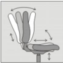
Die Synchronmechanik garantiert perfekten Komfort und Ergonomie dank optimaler Anpassung. Sitz und Rückenlehne folgen synchron den Bewegungen des Sitzenden im richtigen Winkelverhältnis mit Arretierungsmöglichkeit in 3 Positionen. Seitliche stufenlose Federkrafteinstellung des Rückenlehnengegendrucks mit Stellschraube im Bereich von ca. 50 – 135 kg Körpergewicht. Schiebesitz im Verstellbereich von 6 cm, Sitzneigung von  $-3^\circ$ .
