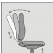
Preisgünstige Einstiegstechnik für bewegtes Sitzen. Rückenlehnenneigung mechanisch individuell verstellbar und stufenlos arretierbar. Mechanische Verstellung der Rückenlehnenneigung.
